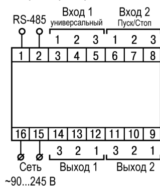
Рисунок 5.2 – Общая схема подключения TPM101
