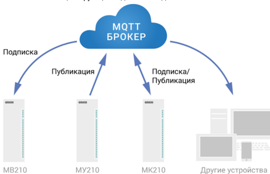
Рисунок 6.2 – Структурная схема обмена по протоколу MQTT
