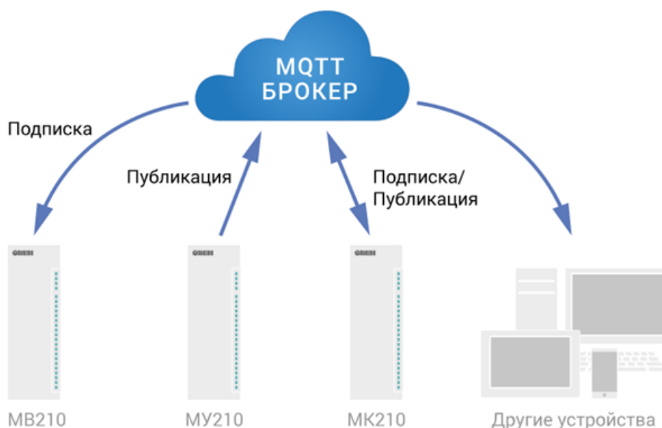
Рисунок 6.2 – Структурная схема обмена по протоколу MQTT
